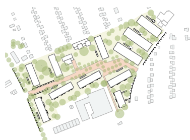
Etappe 3 Autofreie Siedlung / Parkplatzzahl reduziert, Velo 360 St.
