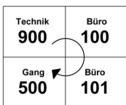
Grafik 6: Schematische Darstellung Nummerierung nach Raumnutzung (NF: 100er-Nr., VF: 500er-Nr., FF: 900er-Nr.)
