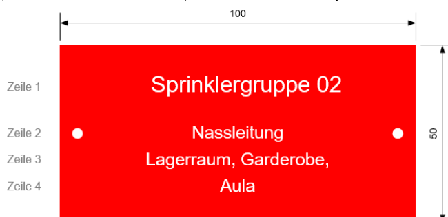
Abbildung 24: Beispiel Bezeichnungsschild Sprinklergruppe
